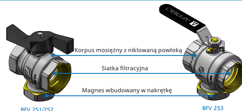
Rys. 2. Budowa zaworu kulowego BFV
