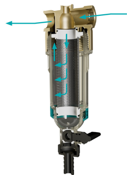
Рис. 1. Схема проходження води через фільтр АWF
