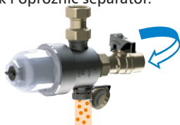
Rys. 9. Separator zanieczyszczeń ADS 110 z zamkniętym zaworem odcinającym i odkręconym korkiem
