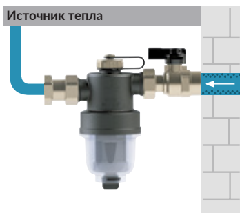
Рис. 2. Монтаж сепаратора шлама ADS 110 на горизонтальном трубопроводе
