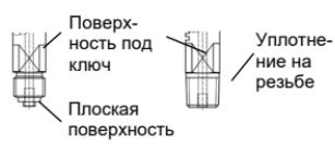
Момент затяжки зависит от используемого уплотнения. Чтобы обеспечить положение манометра, позволяющее легко считывать показания, разрезное соединение должно выполняться с использованием соединения с наружной резьбой и с фиксированной внутренней резьбой или с гайкой.
