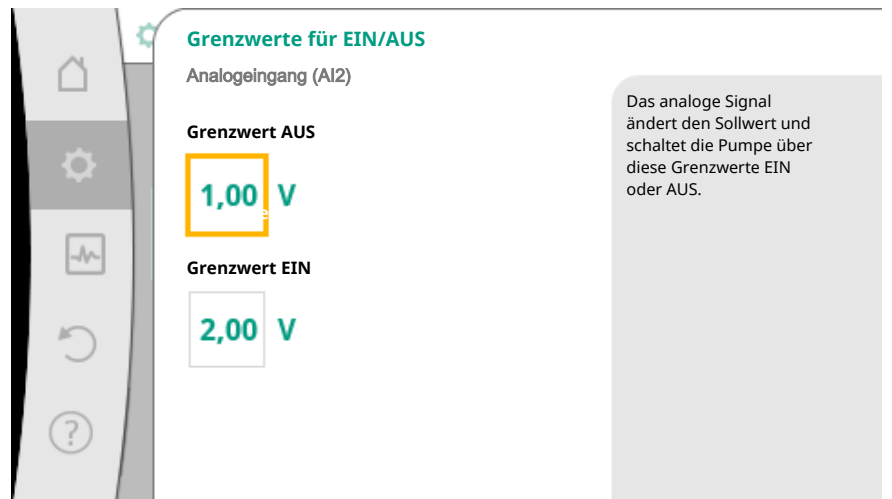
Fig. 74: Grenzwerte zur EIN/AUS-Steuerung über Analogsignale
