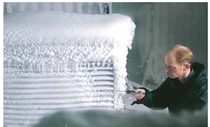
Komory klimatyczne symulują wszystkie potencjalne warunki eksploatacji
