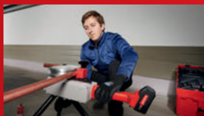
Segmenty gnące z kutego aluminium ze wskaźnikiem kąta gięcia
