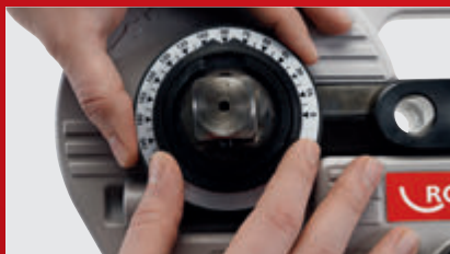
Wstępne ustawienie kąta gięcia bez dodatkowych narzędzi
