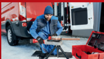
Wstępne ustawienie kąta gięcia bez dodatkowych narzędzi
