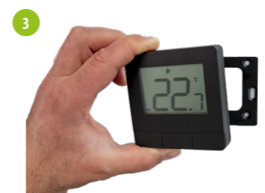
Zamocuj regulator na płytce montażowej.
