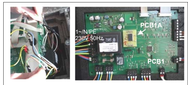
Abb. 4.11 Hauptplatine PCB1 mit Echtzeituhr-Platine PCB1A
