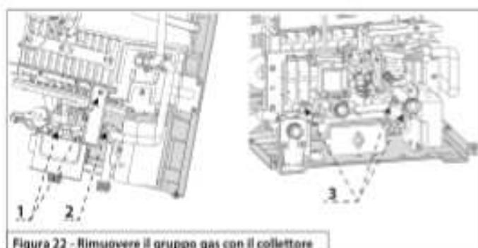
Figura 22 - Rimuovere il gruppo gas con il collettore
