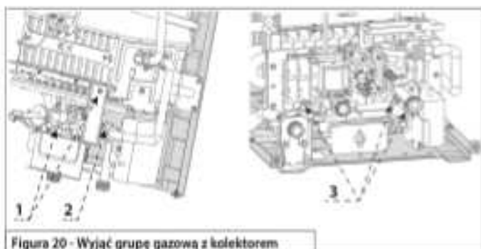
Figura 20 - Wyjęć grupę gazową z kolektorem
