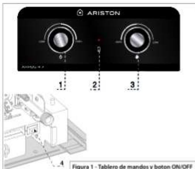
Figura 1 - Tablero de mandos y boton ON/OFF
